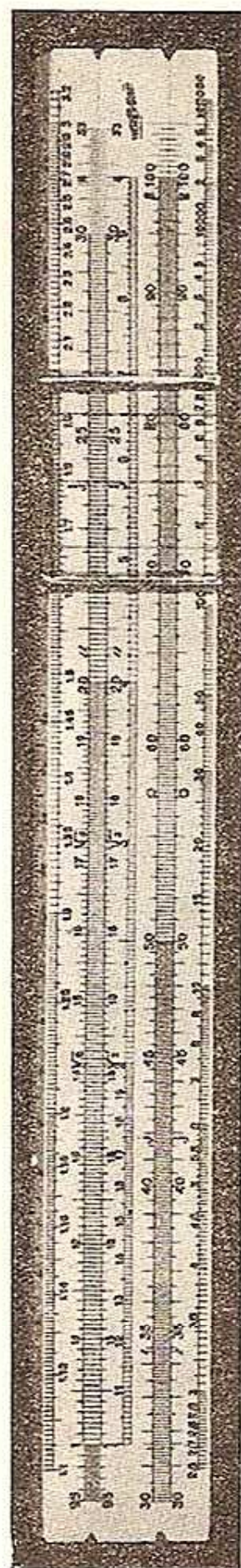
FIGURE 12. — La règle physicien de M. Ginat et ses échelles repliées, qui procurent une grande précision de lecture (document Tavernier-Gravet).
